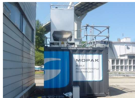
Installation mobile de dosage du CAP (Schaub) pour les essais
